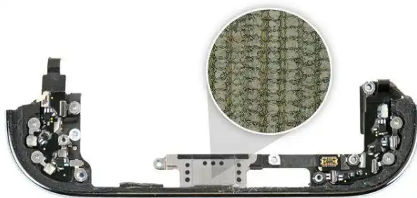
图 25：iPhone 17 Air USB-C 接口外壳的 3D 打印工艺
