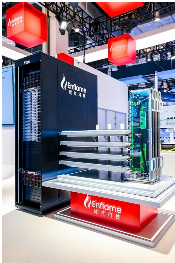
图表13：正交零线缆超节点对板端与正交高速连接提出更高要求
