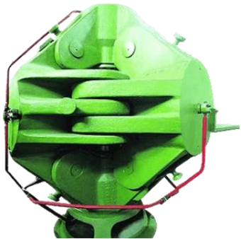
六面顶压机结构图
