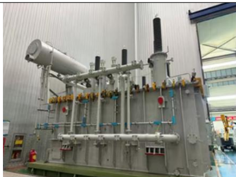
图12: 浙变电气美国德州 130MVA 变压器扩建项目产品
