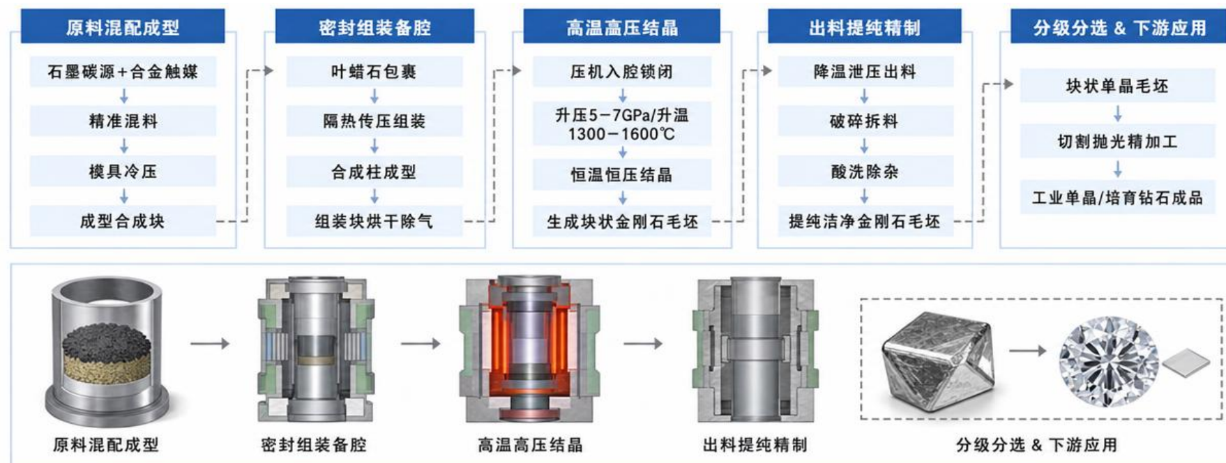
图1：高温高压法（HPHT）培育钻石工艺流程
