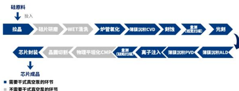
图表 2：集成电路制造工艺流程中大量核心环节需要使用干式真空泵
