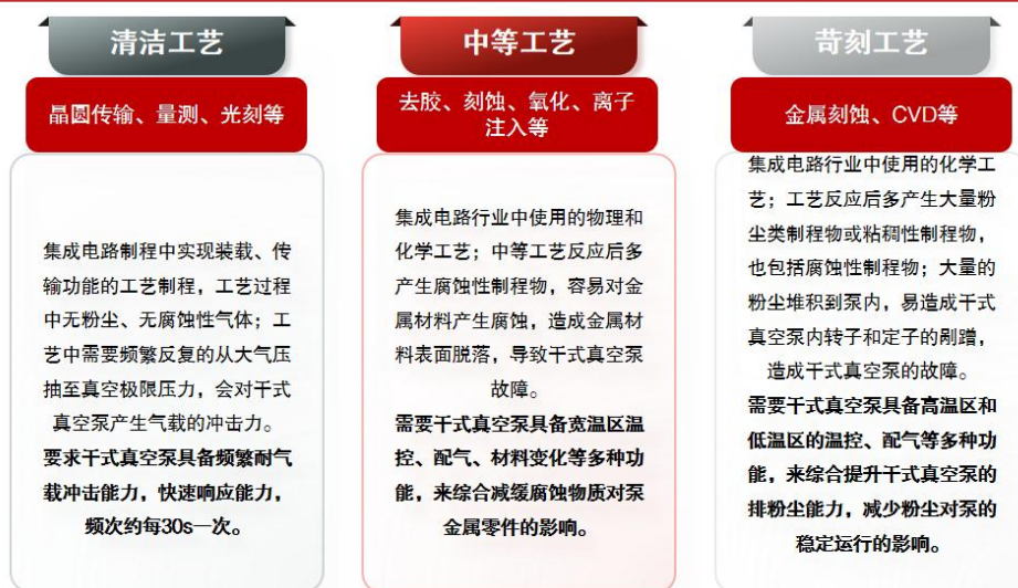
图表 33：苛刻工艺的干式真空泵主要用于金属刻蚀、CVD 等环节
