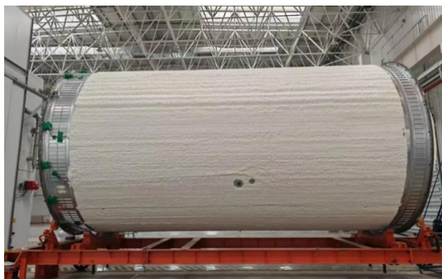
图表12：星际荣耀使用搅拌摩擦棒工艺制造的贮箱
