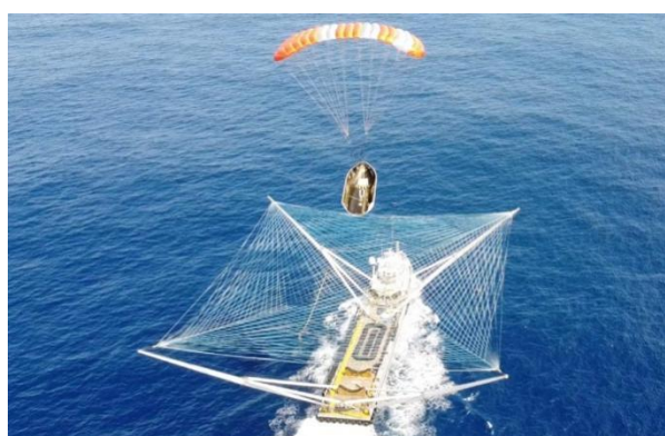
图表10：SpaceX 火箭对整流罩进行“捕捞式”回收
