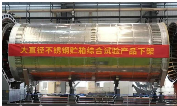
图表13：航天一院研制我国首个5米大直径不锈钢贮箱
