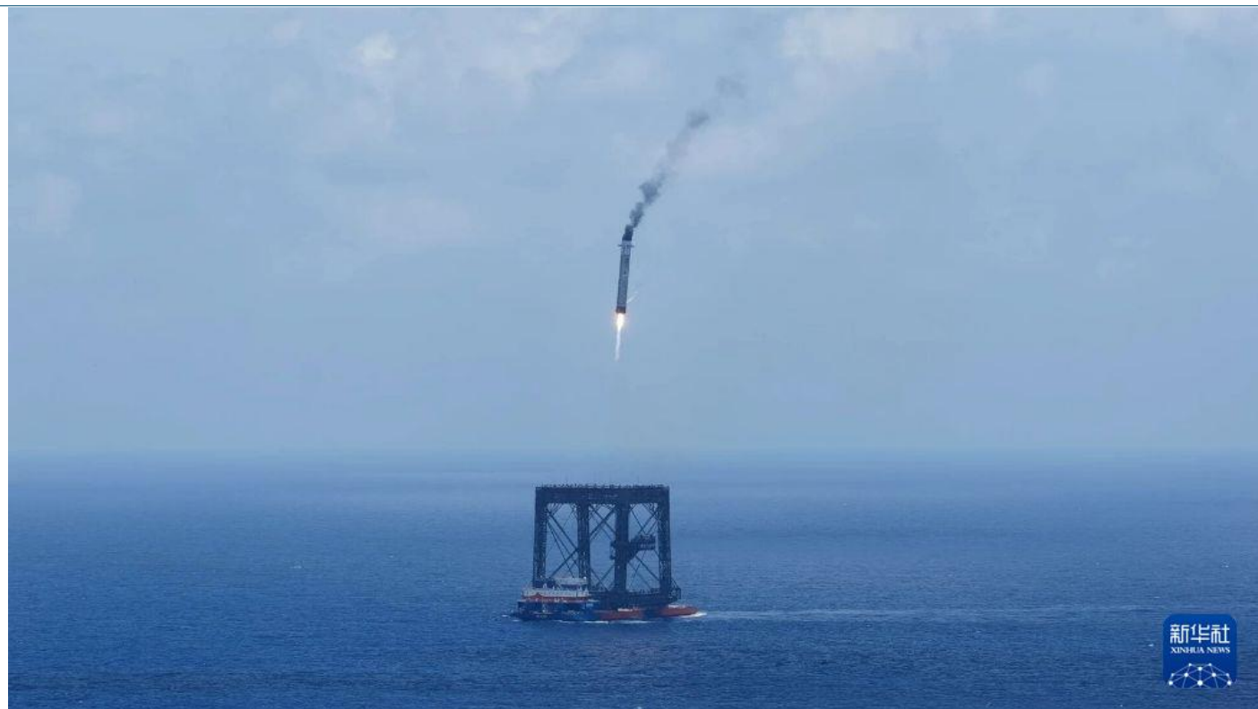
图表2：海上回收平台通过网系捕获方式成功回收长征十号乙运载火箭一子级
