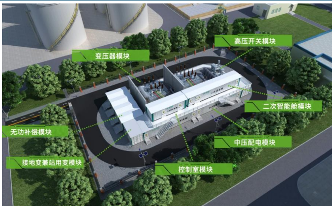
图表16：公司智慧模块化变电站示意图：像“搭积木”一样建电站
