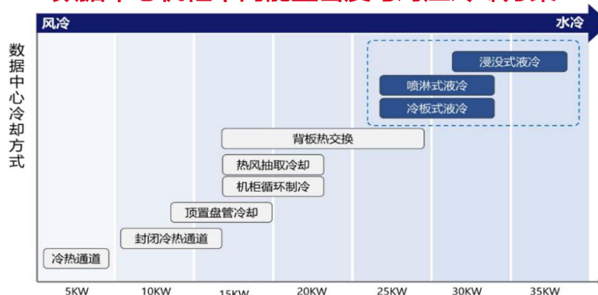
数据中心机柜不同能量密度与对应冷却方案
