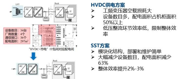
图 31：数据中心 SST 方案与 HVDC 方案对比
