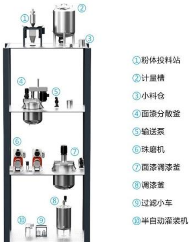
图22: 油墨涂料自动化生产线基本结构
