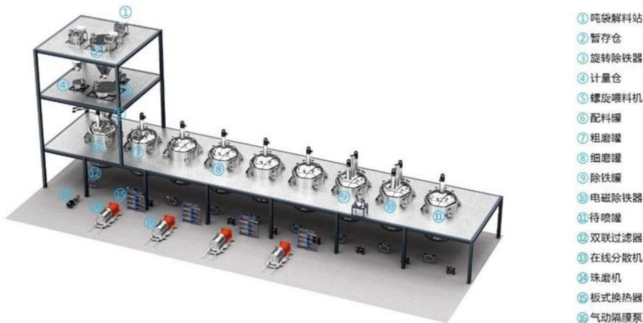
图21：磷酸铁锂正极材料预混研磨工段物料自动化生产线
