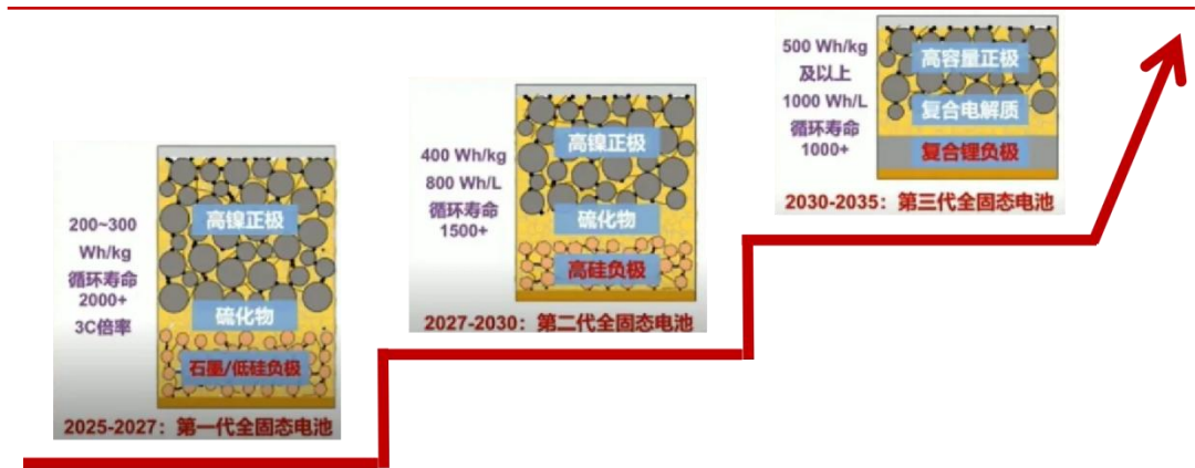
图29：以硫化物为主体电解质的全固态电池发展路径
