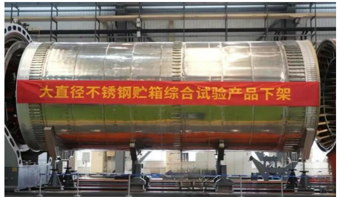
图表22：航天一院研制我国首个5米大直径不锈钢贮箱
