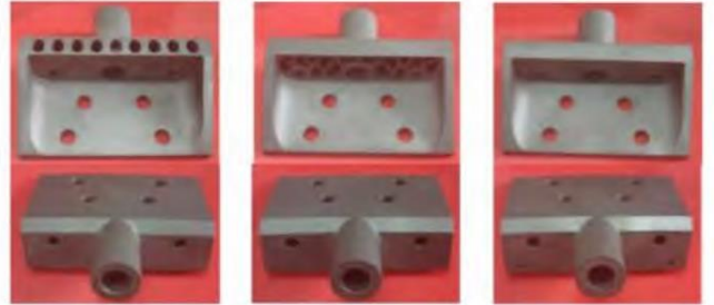
a 中空夹层结构 b 薄壁加筋结构 c 镂空点阵结构
