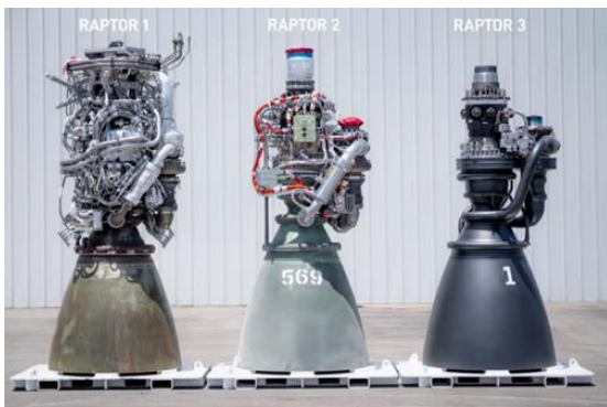
图表28: SpaceX猛禽第一至三代发动机外观对比, 管路显著减少, 结构、外形发生明显简化
