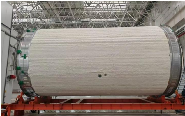
图表21：星际荣耀使用搅拌摩擦焊工艺制造的贮箱
