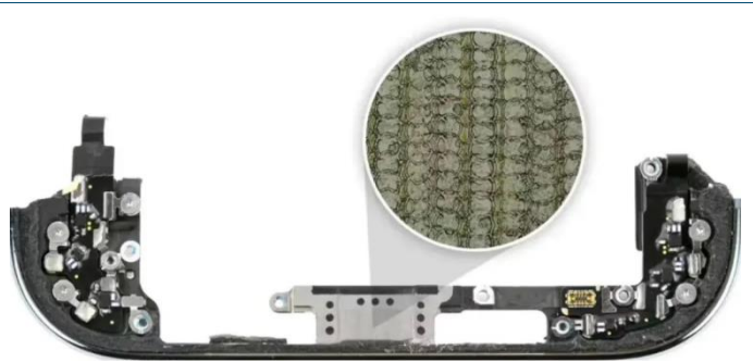
图表32: 苹果 iPhone Air USB-C 接口采用 3D 打印技术
