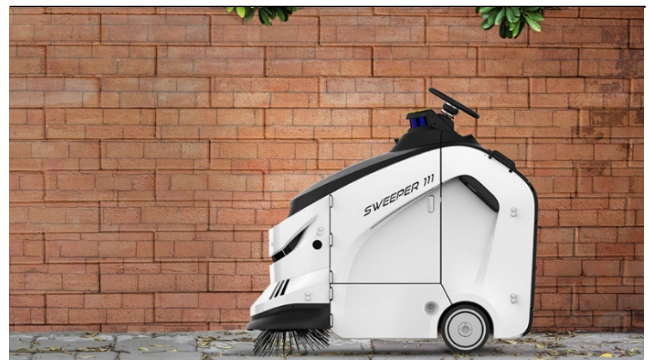
图表 230：高仙清洁机器人搭载奥比中光 3D 视觉传感器，可以自动识别、清理垃圾，并在复杂户外环境中自动避障
