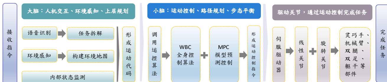
图表 33：基于感知模块、决策模块、运控模块，人形机器人完成从指令接受到任务执行的全过程
