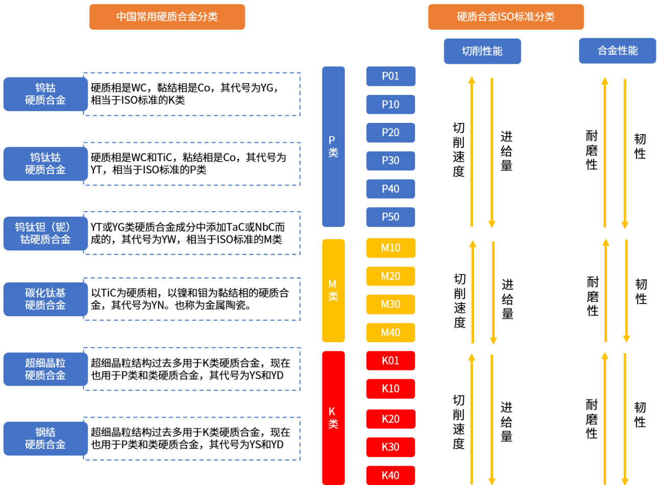
图表13: 不同配方下的硬质合金性能差异较大
