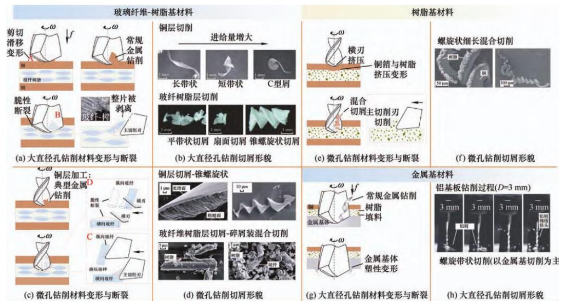
图表 15：PCB 多种材料对钻针性能带来巨大挑战
